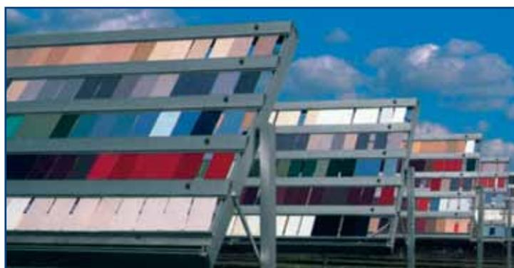
Sayerlack ha scelto la Florida perché le condizioni climatiche in cui opera il **Q-LAB Weathering Research Service** sono le più impegnative per i test cui sottoporre i legni trattati con vernici per esterno:
